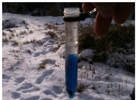
写真3 凍結深度計による凍土厚の確認
