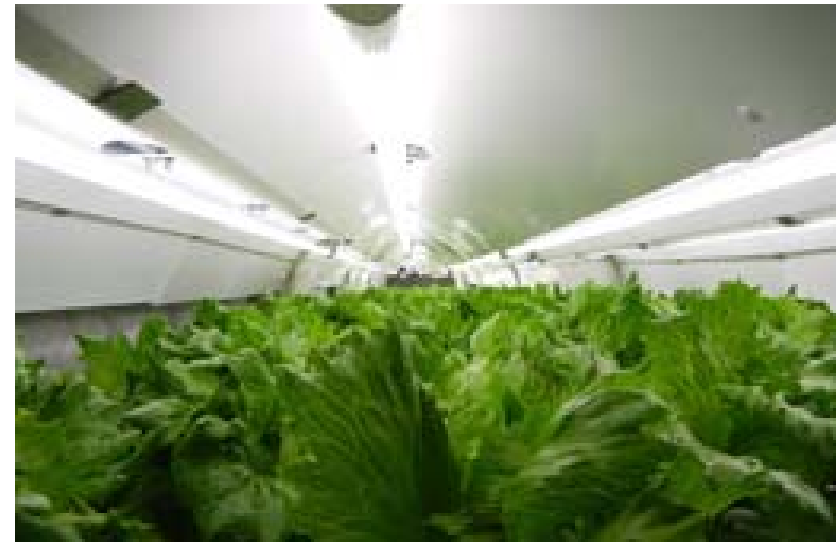
人工光のみを用い、栽培空間を外気から完全に隔離した植物工場完全閉鎖型工場)
