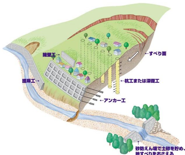
地すべり工事
