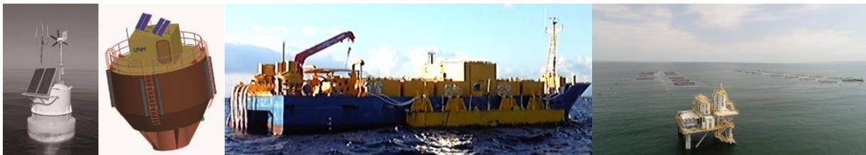
図2 左より、米国(Fullerton et al., 2004; Turmelle et al, 2006)の給餌ブイ、日本の給餌バージ船(筆者撮影)、給餌タワー(新日鉄住金エンジニアリング株式会社提供)
