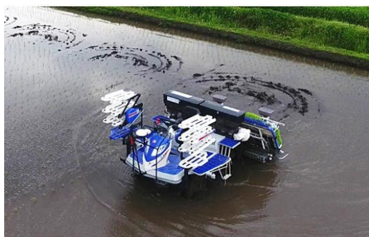
自動運転田植機は、熟練者並みの作業精度が誰でも得られ、省力化に貢献
