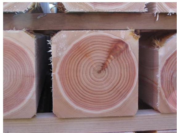
図2 乾燥直前のヒノキ製材の白線帯
