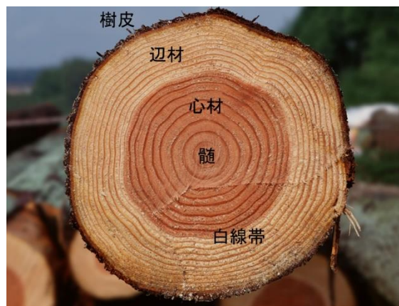
図 1 スギ丸太の木口断面
