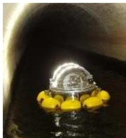
水路トンネルを断水することなく、壁面画像をカメラで捉えることで点検できる。
