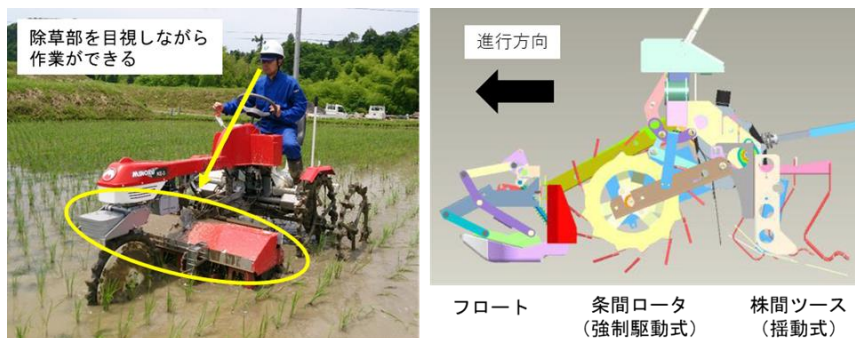
図 1 高能率水田用除草機による除草作業(左)と除草機構(右)
