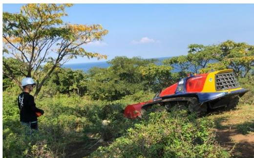
写真 6 無線トラクタ装着型フレールモア
