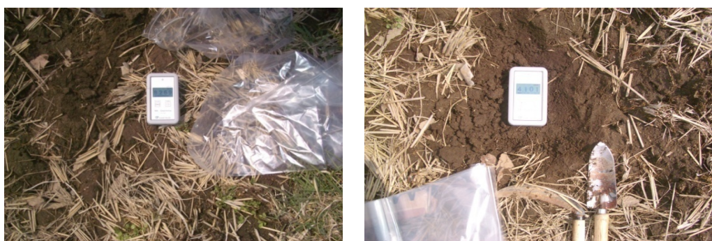
a) 土壌表土面（有機物除去：8.26 \mu Sv/hr） b) 表土はぎ後（1回目:4.10 \mu Sv/hr）
