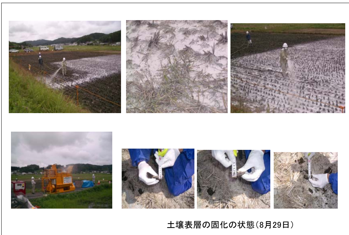
写真6 現地実証試験マグネシア系固化剤の吹き付け状況(平成23年8月20日)
